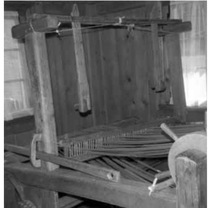
Geschlossener Windràcha mit eingelegten Kettfäden am Webstuhl.
