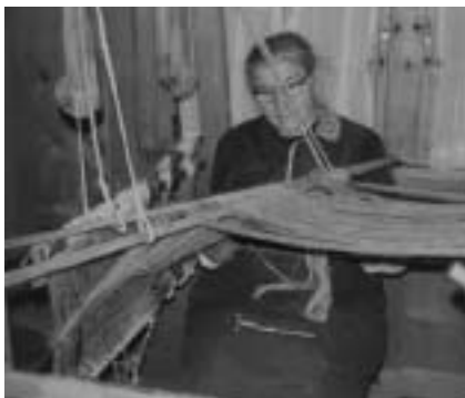
Magdalena hat die Kreuzstäbe (16) ins Fadenkreuz gelegt und zieht die Fäden in die Ösen der Schäfte.
